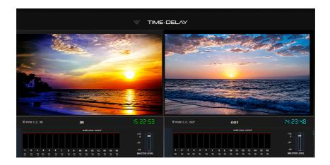
O Time Delay dispõe de dois monitores. O monitor "IN" exibe o sinal de entrada que pode ser proveniente de Webrtc, NDI, Placa e etc. Já o monitor OUT transmite o sinal de saída com delay.
